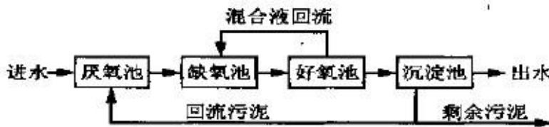
图 5 传统 A 2 /O 工艺流程(Phoredox 3 阶段生物除磷脱氮工艺)
